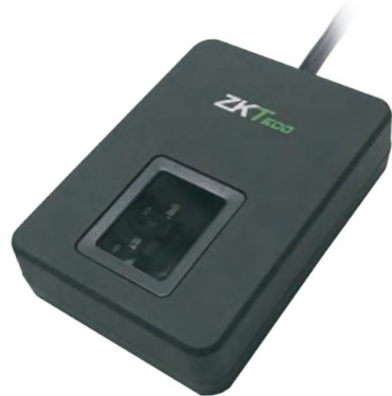
ZK9500, es el último escáner óptico de huellas digitales, desarrollado por ZKTeco. El escáner realiza la detección de dedos y captura la imagen de la huella digital rápidamente y con alta resolución.
